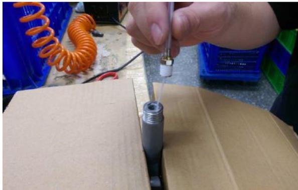
7. Den blauen Tornador-Schlauch (A) über den innenliegenden Schlauch (C) führen und mit SW10 in das Gehäuse (B) einschrauben.
