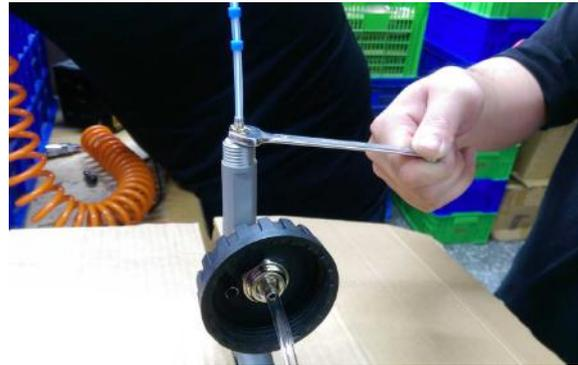
2. Die SW10 Schraube mit dem blauen Tornador-Schlauch (A) aus dem Gehäuse (B) schrauben. Eventuelle Reste vom Dichtungsband aus dem Innengewinde des Gehäuses entfernen.
