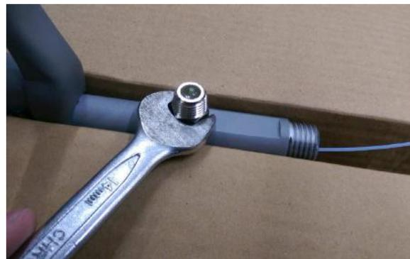
4. Anschließend mit SW14 das Gewinde mit dem Schlauch aus dem Gehäuse herausdrehen.
