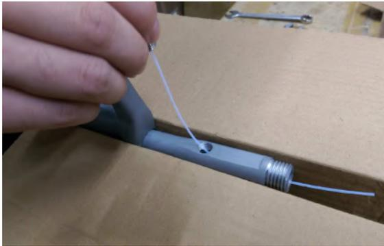
5. Das neue Ersatzteil (C) mit dem innenliegenden Schlauch mit SW14 in das Gehäuse schrauben. Anschließend die Umstell-Einheit mit SW16 aufschrauben und mit SW14 kontern.
