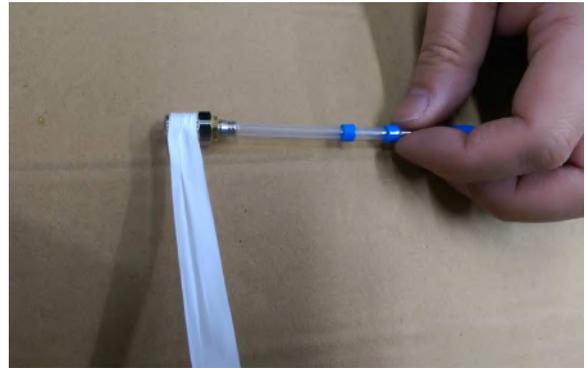
6. Das Gewinde des blauen Tornador-Schlauches mit Dichtungsband umwickeln und überstehendes Dichtungsband mit einem Messer entfernen.
