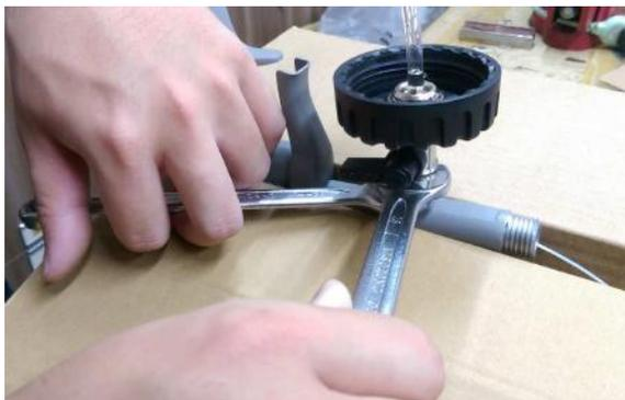
3. Die Umschalt-Einheit (D) mit SW16 von der darüberliegenden Mutter SW14 (C) abschrauben. Dabei mit einem Maulschlüssel der Gr. SW14 kontern.
